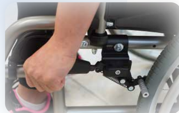
使用者上落輪椅或停泊時， 要把剎掣按下，避免輪椅移動
